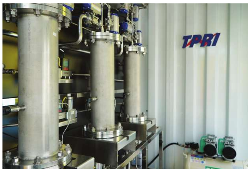
圖 2 固態吸附法三塔式變壓吸附分離主設備
