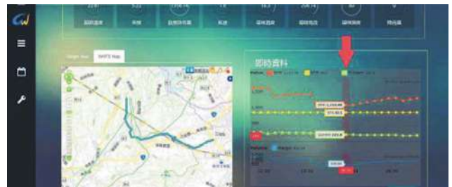
圖 4 應用管理平台 (提供設備監測數據之顯示畫面與動態熱容量之估算值，提供線路溫度、弛度、預估動態熱容量值、風速、環境溫度、環境濕度、降雨量等監測資訊。)
