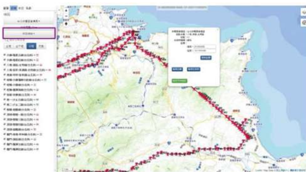
圖 3 架空線路於地圖上顯示 於設備圖層可依供電區營運處、電壓別等，查詢欲顯示之架空線路。
