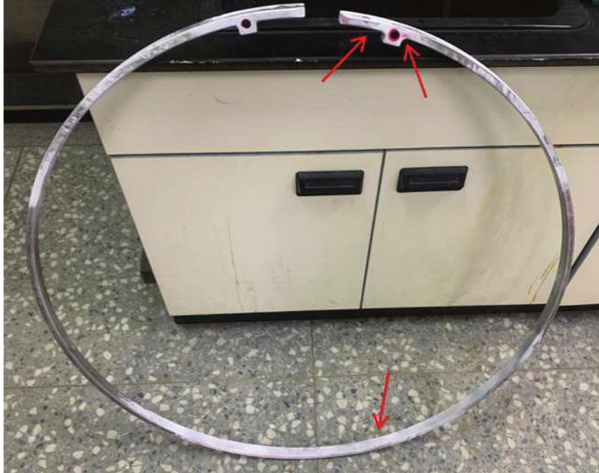
圖 1 南部發電廠 GT11 發電機轉子扣環內 Locking Ring 發現有裂紋
